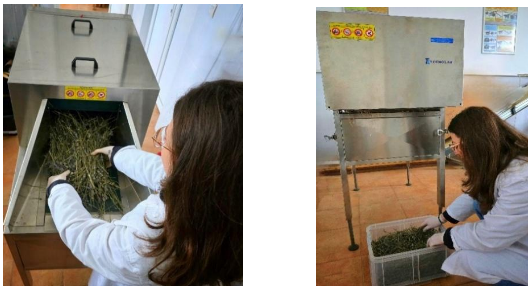
Fig. 5.3 - Aspecte din timpul mărunțirii mecanizate a plantelor medicinale și aromatice cu HERBCUT TIMATIC
