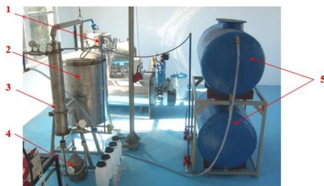
Fig. 3.1 - Instalație de distilare cu abur a plantelor medicinale și aromatice, IDP500 1 - generator abur, 2 - recipient distilare, 3 - condensator vapori de ulei, 4 - separator ulei, 5 - rezervoare apă
